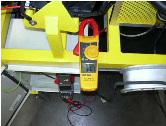
Anh.-Bild 1 Messung mit dem Zangenamperemeter
