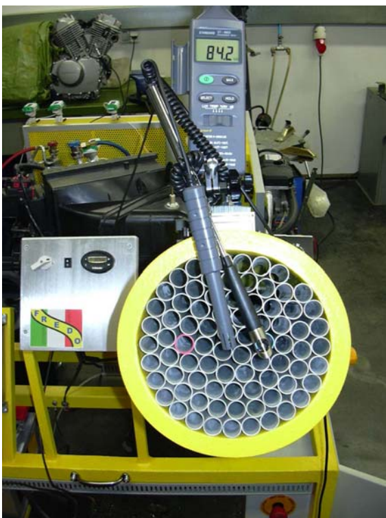
Anh.-Bild 2 Messung der Ausblasgeschwindigkeit und Luftfeuchte
